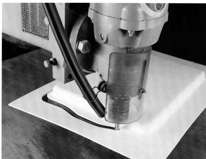
Liigse materjali eemaldamine valatud detaililt šablooniga profiilfreesi abil.
