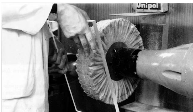
Poleerimine riidekattega kettaga.
