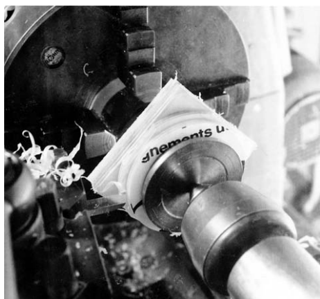
Toorikute treimine ümmargusteks ketasteks treipingi padruni ja tagapuki vahel.
